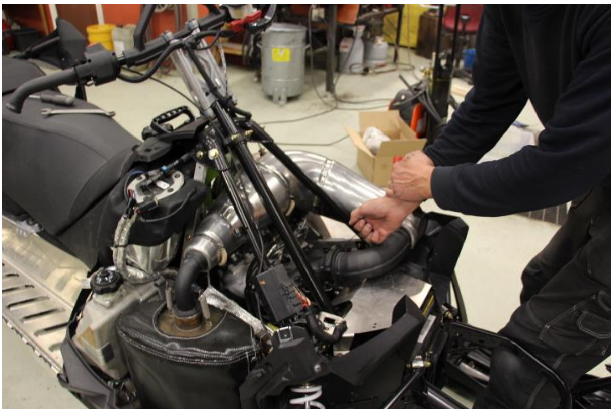
Ta loss expansionspipan. Ljuddämparen kan sitta kvar.
